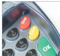
Tastatur mit ergonomischem Sichtschutz und taktilen Symbolen
